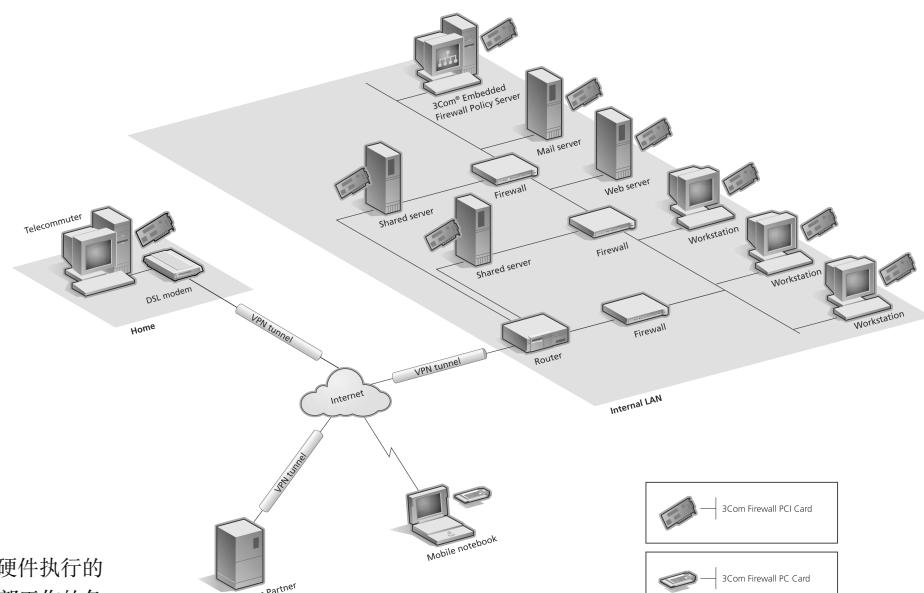
3Com 嵌入式防火墙解决方案将硬件执行的防火墙功能扩展到了在局域网内部工作的各个用户以及局域网外部的远程用户。
